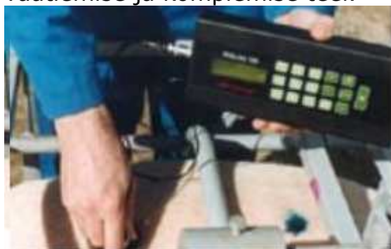
Foto 1. Lihajõudluse mõõtmine Piglog-105ga
